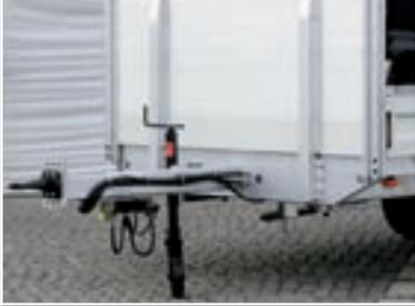
Rohrzugdeichsel mit klappbarem Stützrad
