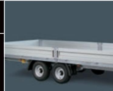
Mittelrune, geteilte Bordwände seitlich (nicht in Verbindung mit Plane und Spiegel)
