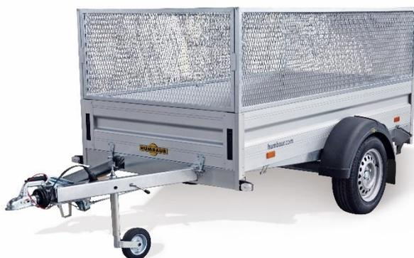
Zubehör: Stahlgitteraufsatz 620 mm
