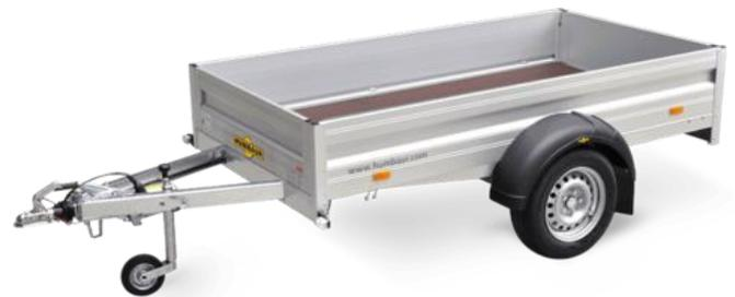
Serienmässig mit klappbarem Rückladen. Optional mit klappbarer Frontwand
